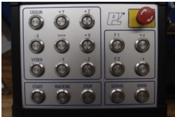
Obr. 4 Ovládací panel pre manuálne ovládanie technického komplexu.
