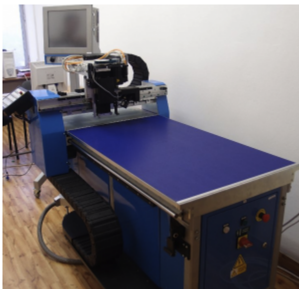
Obr.1 Fyzikálny model plazmového rezacieho centra
