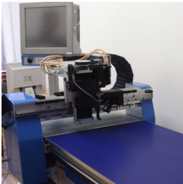
Obr.2 Fyzikálny model plazmového rezacieho centra
