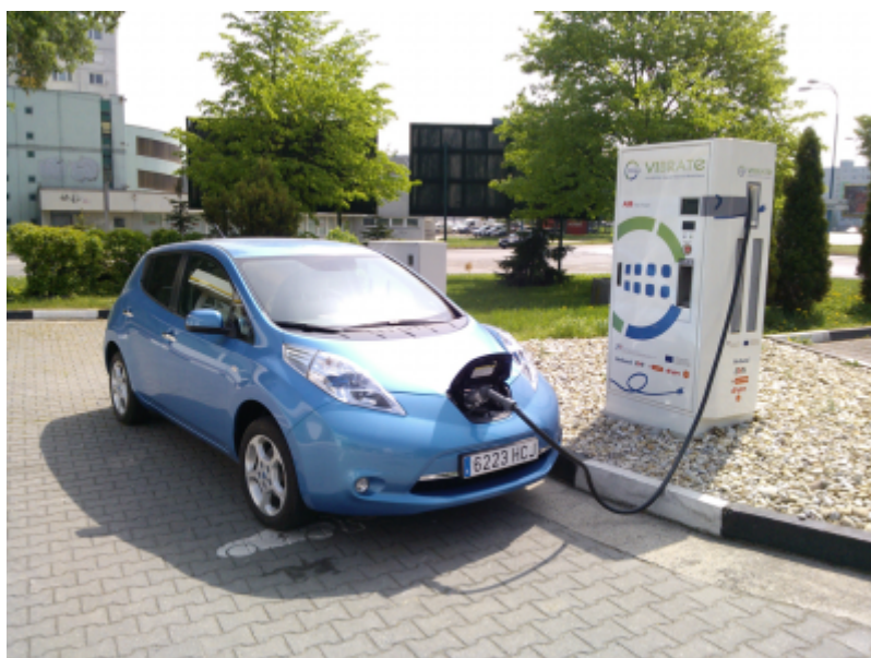
Obr.3 Elektromobil Nissan Leaf na rýchlo-nabíjacej stanici projektu VIBRATE v
