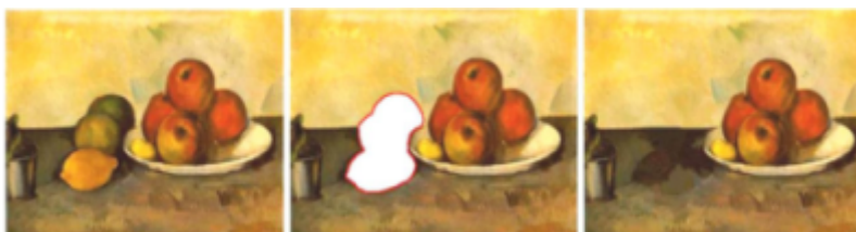
Obr. 4 Príklad úspešného doplnenia hrany a vyplnenia textúry pomocou metódy Exemplar-Based Image Inpainting
