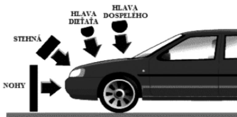
Obr. 10 Schéma zrážky vozidla s chodcom
