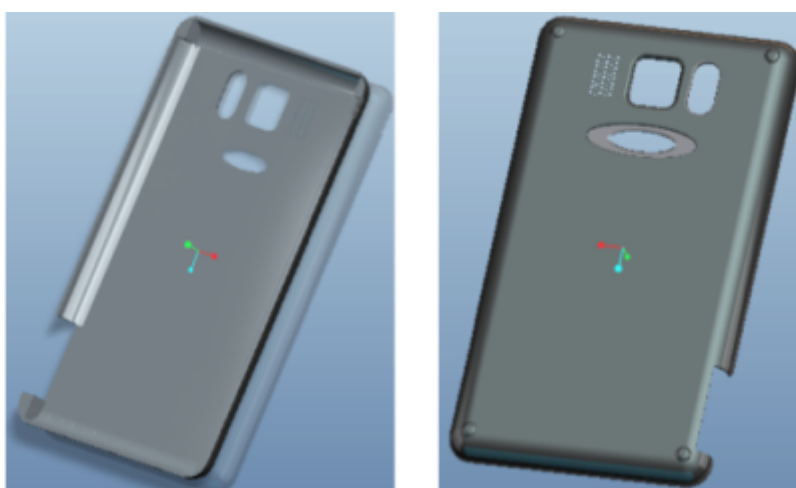
Obr. 1 Konštrukčný 3D CAD návrh zadného krytu mobilného telefónu
