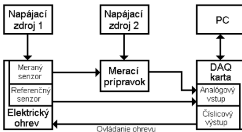
Obr.1 Blokovaná schéma pracoviska pre meranie teploty
