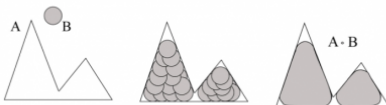
Obr. 4 Vstupná množina A a štruktúrny element B (vľavo), pohyb štruktúrneho elementu objektom (v strede), výsledok otvorenia - zjednotenie plochy pohybu štruktúrneho elementu (vpravo).
