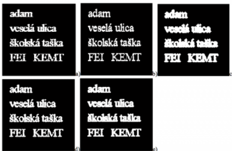
Obr.7 Morfologická dilatácia vstupného obrazu so štruktúrnym elementom typu: a) horizontálna čiara veľkosti 3x1 op, b) vertikálna čiara veľkosti 1x3 op, c) diamant so šírkou 2 op od reprezentatívneho bodu, d) kríž veľkosti 1 op v kolmých smeroch, e) štvorec veľkosti 3x3 op.
