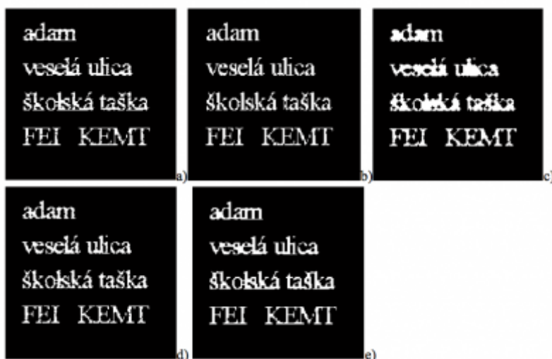
Obr.10 Morfológické zatvorenie vstupného obrazu štruktúrnym elementom a) horizontálna čiara veľkosti 3 \times 1 op, b) vertikálna čiara veľkosti 1 \times 3 op, c) diamant so šírkou 2 op od reprezentatívneho bodu, d) kríž veľkosti 1 op v kolmých smeroch, e) štvorec veľkosti 3 \times 3 op.
