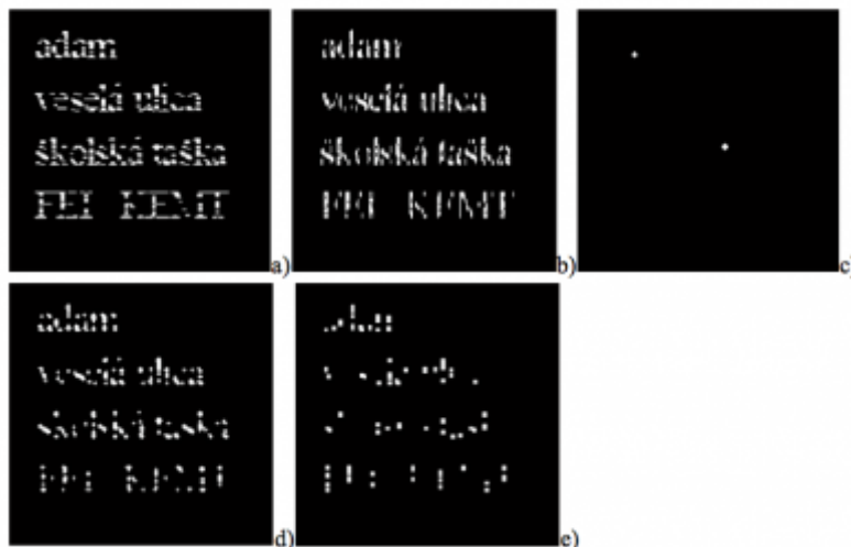
Obr.9 Morfológické otvorenie vstupného obrazu štruktúrnym elementom a) horizontálna čiara veľkosti 3x1 op, b) vertikálna čiara veľkosti 1x3 op, c) diamant so šírkou 2 op od reprezentatívneho bodu, d) kríž veľkosti 1 op v kolmých smeroch, e) štvorec veľkosti 3x3 op.
