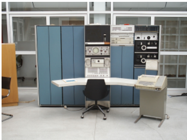
Obr. 4. PDP-7 s konzolou, vyrábaný od roku 1965, tento kus funguje od roku 1985 v múzeu počítačov v OSLO. Nikdy sa nereštartoval a v roku 2009 ho prvý raz na 4 mesiace vypli kvôli rekonštrukcii, ktorá sa skončí v roku 2010 [4]
