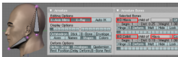
Obr.1: Pozice základní kosti a nastavení armatury.
