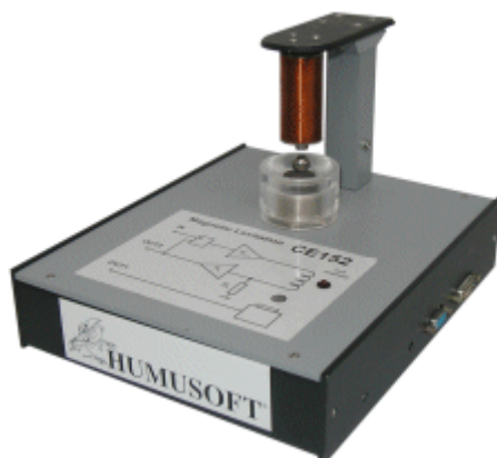
Laboratorní model Magnetická levitace
