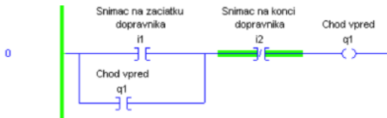
Obr. 7 Ovládanie modelu dopravníka s využitím inštrukcie OTE
